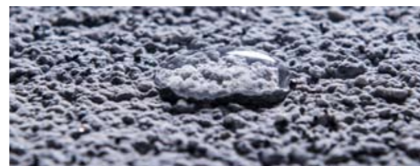
Povrch omítky odpuzuje vodu.
