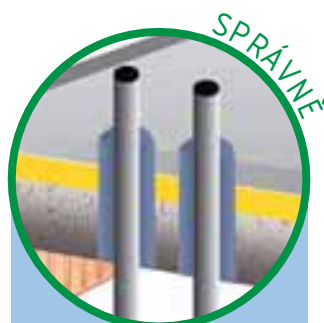
Prostupy stropem - izolované trubkové vedení.
