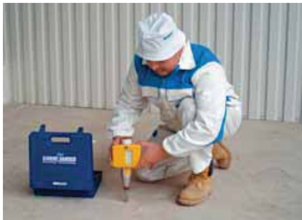
Kontrola Schmidovým kladívkem
