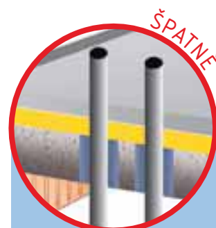
Chybějící izolace trubkového vedení v potěru - nebezpečí lomu, vznik zvukových mostů.
