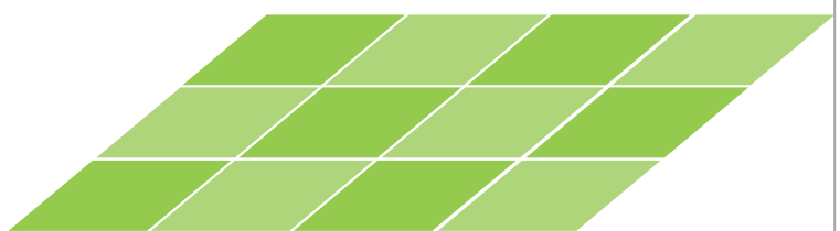
správně položené dlaždice
