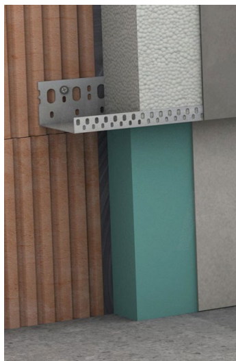
Osazení základací lišty a extrudovaného polystyrenu
